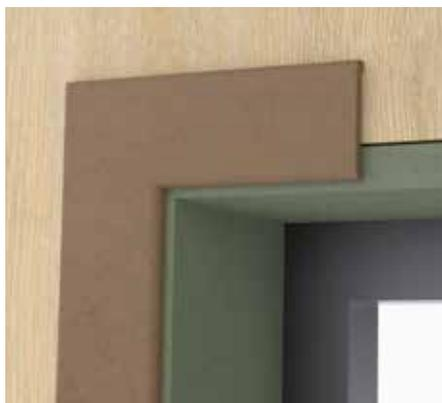
Finition fenêtre avec MDF et moulure de fenêtre.
