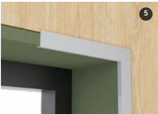
Rahmenverarbeitung mit MDF und Aluminiumeckprofil.
