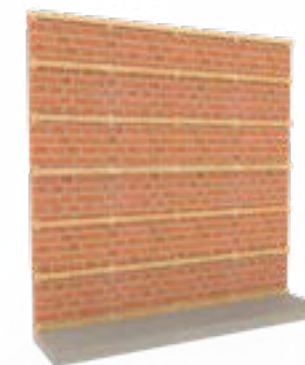
Holzlatten direkt auf der Mauer
